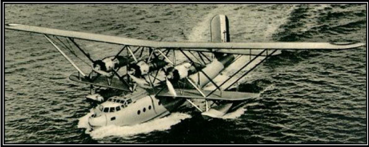
Hydravion de reconnaissance biplan dont le premier vol remonte au 11 septembre 1933, et mis en service à partir de 1935 au sein de la Marine Française. Un modèle civil, le Breguet-530 Saïgon, pouvant transporter une vingtaine de passagers a été développé. L'avion est équipé de 4 mitrailleuses sur les flancs ainsi que d'une mitrailleuse de queue (Darne cal. 7,5mm.), et peut emporter une charge de bombes de 300 kg sous les ailes (4 x 75 kg).
